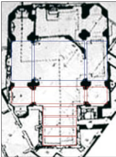
FIGURA 6.—Reconstrucción de los tramos de bóveda perlongados en la iglesia de San Agustín, a partir del plano de 1815, realizado por fray Joaquín del Niño Jesús.
